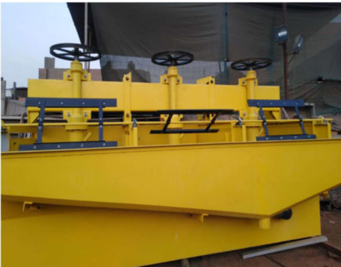
Fabricación de celdas de flotación Sub A
